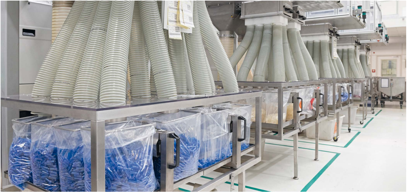
Die kavitätensortierte Ablage und Verpackung der Spritzgussteile sichert die Minimierung von Fehlereinflüssen und die Rückverfolgbarkeit bis in die Fertigung.
