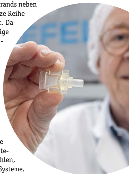
Twist Off Port aus PVC für Blutbeutel-systeme weisen eine durchstechbare Membran auf und überstehen ohne Funktionseinbußen den Schrumpf nach der Sterilisation.
